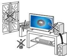
Не устанавливайте телевизор вблизи источников тепла, таких как батареи центрального отопления, тепловые радиаторы, обогреватели, печи или другие устройства (включая усилители), генерирующие тепло.
