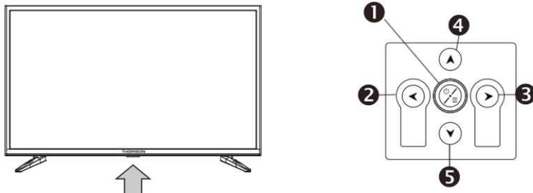
Рис. Расположение панели кнопок управления
